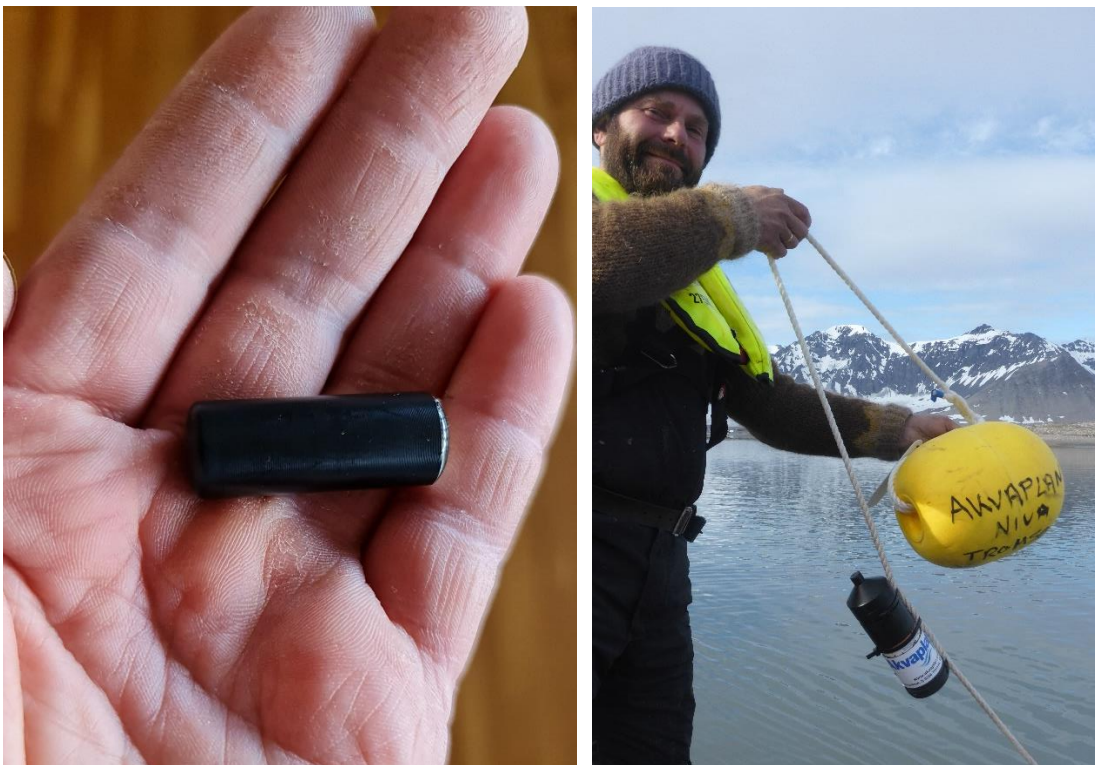
Figur 17. Akustisk merker (ThelmaBiotel) av typen MP13 ble benyttet til merking av pukkellaks og sjørøye. Høyre: Rigg med akustisk logger (ThelmaBiotel). Logger ble plassert 2 meter under flytebøye. Foto: Akvaplan-niva.
