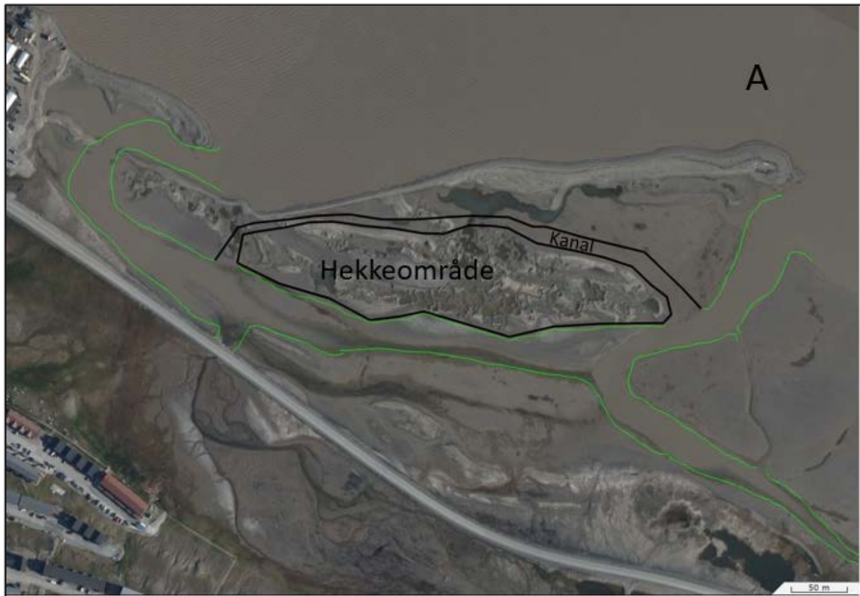
Figur 6. Tiltaksområde A. Etablering av hekkeområde hvor fjellrev må svømme om den skal nå ut. Grønn arrondering gjengir eksisterende vannveier i området under lavvann. Det planlegges å gjøre disse vannveiene dypere og bredere. Dvs. at kanalen ikke er smalere enn ti meter på det smaleste. Svart strek gjengir foreslått hekkeområde. Innenfor dette området flyttes masser, slik at det blir mange vannspeil mellom partier som blir høyere enn 0,5 meter over øverste nivå for høyvann. Landskapet i dette området vil da bli dekt av små grusrygger omgitt av vann. Kanalen på nordsiden av hekkeområdet må også graves slik at den blir omkring 10 meter bred. Dagens strandvoll skal være urørt, og vil ha funksjon som buffer mot bølger.
