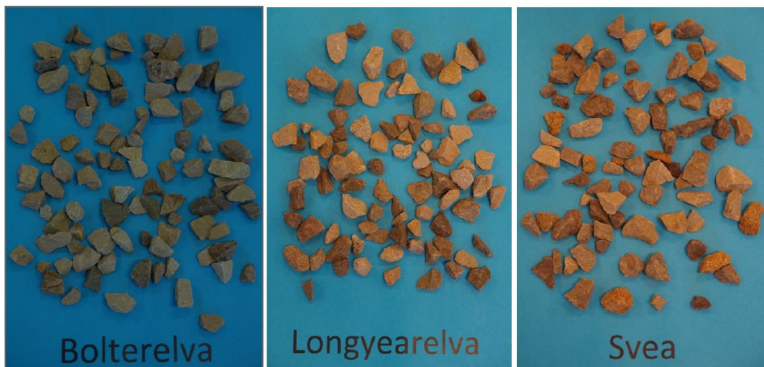
Foto nr. 1: Bildet er hentet fra laboratorierapporten til SINTEF, og viser nedknust tilslagsmateriale i fraksjonen 8-16 mm fra Bolterelva, Longyearelva og Svea.
